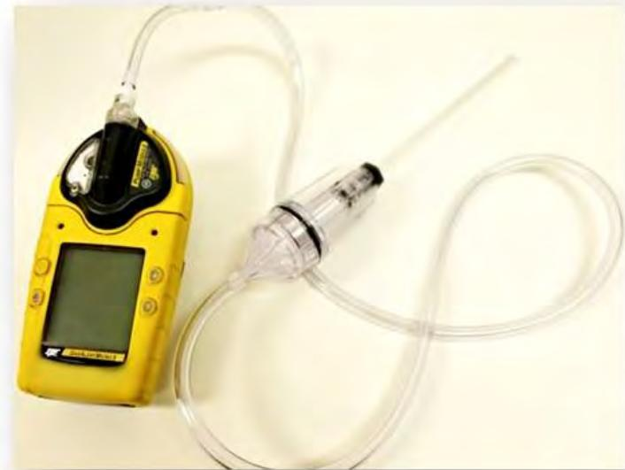
Medidor portátil de gases
